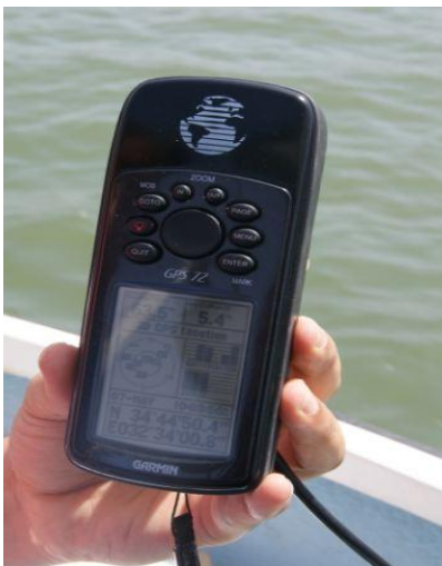
Εικόνα 20: Χρήση GPS για ακριβή καθορισμό των σταθμών δειγματοληψίας
