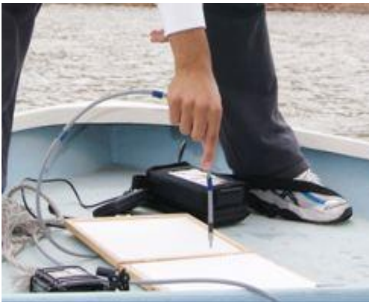
Εικόνα 22: Τιμή reference με τη χρήση άσπρου στόχου
