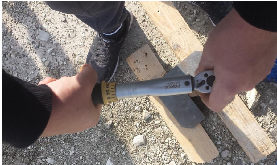
Εικόνα 4: Μέτρηση ροπής με το δυναμόκλειδο. Αντίσταση σε διάτμηση στη διεπιφάνεια πρότυπου κώνου DPL - εδάφους
