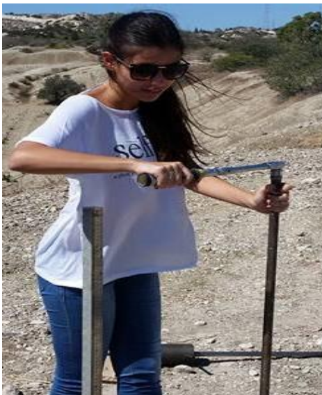
Εικόνα 9: Μέτρηση ροπής με δυναμόκλειδο
