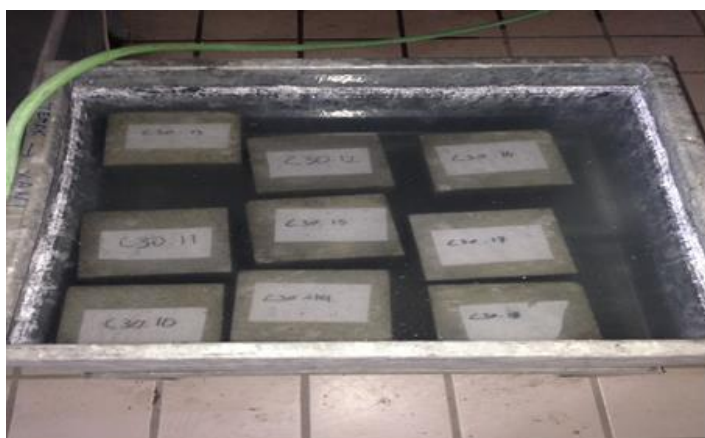
Εικόνα 11. Δεξαμενή νερού για ενυδατωθεί δηγματων.
