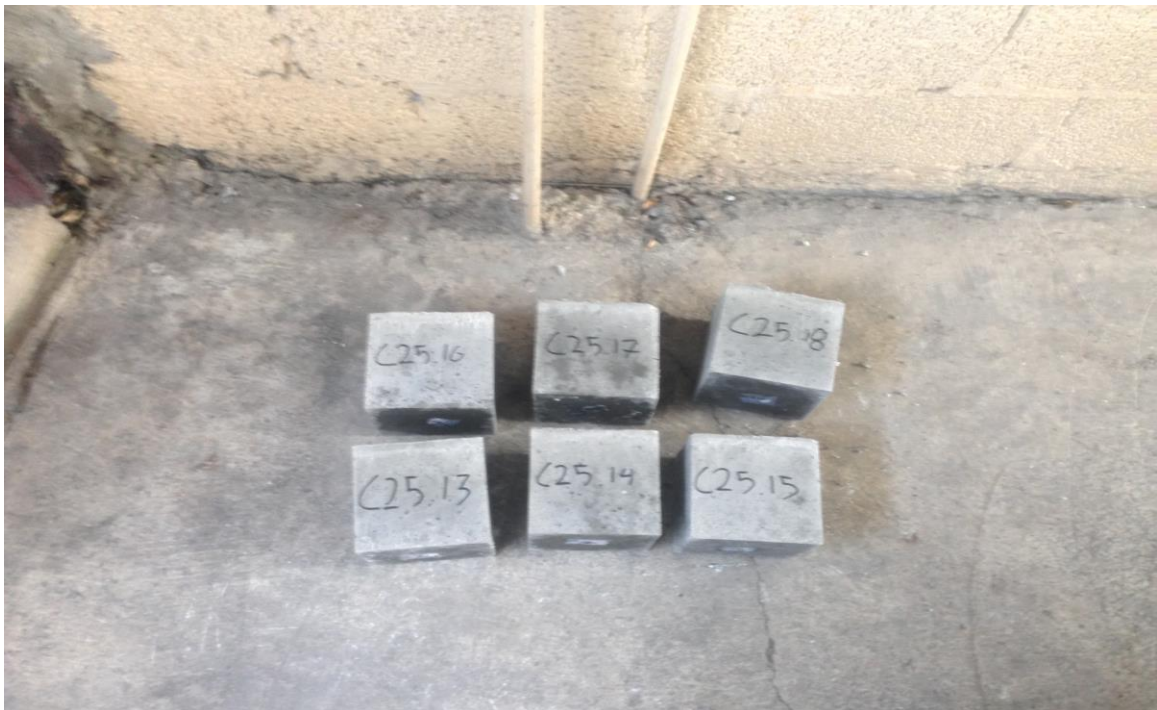
Εικόνα 13. Δοκμια σε θερμοκρασιες δωματιου.
