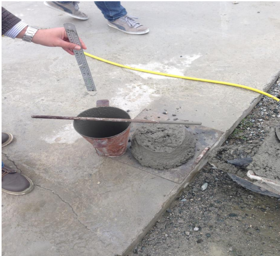
Εικόνα 7. Υπολογισμός κάθισης σκυροδέματος.
