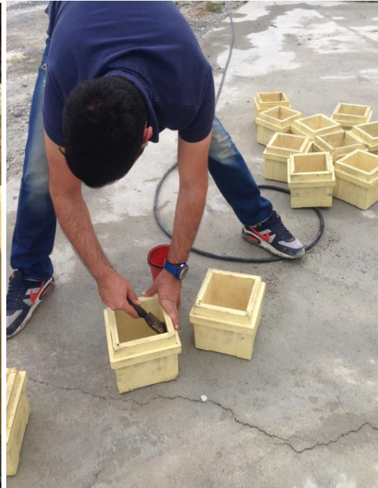
Εικόνα 9. Λάδωμα μήτρας με λαδι.
