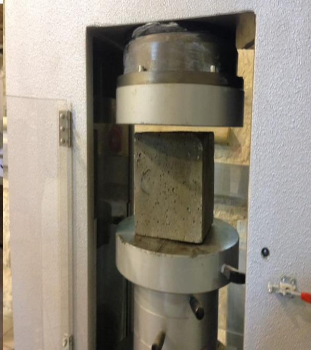
Εικόνα 15. Τοποθετηση δοκιμιου σε μηχανή θλίψης
