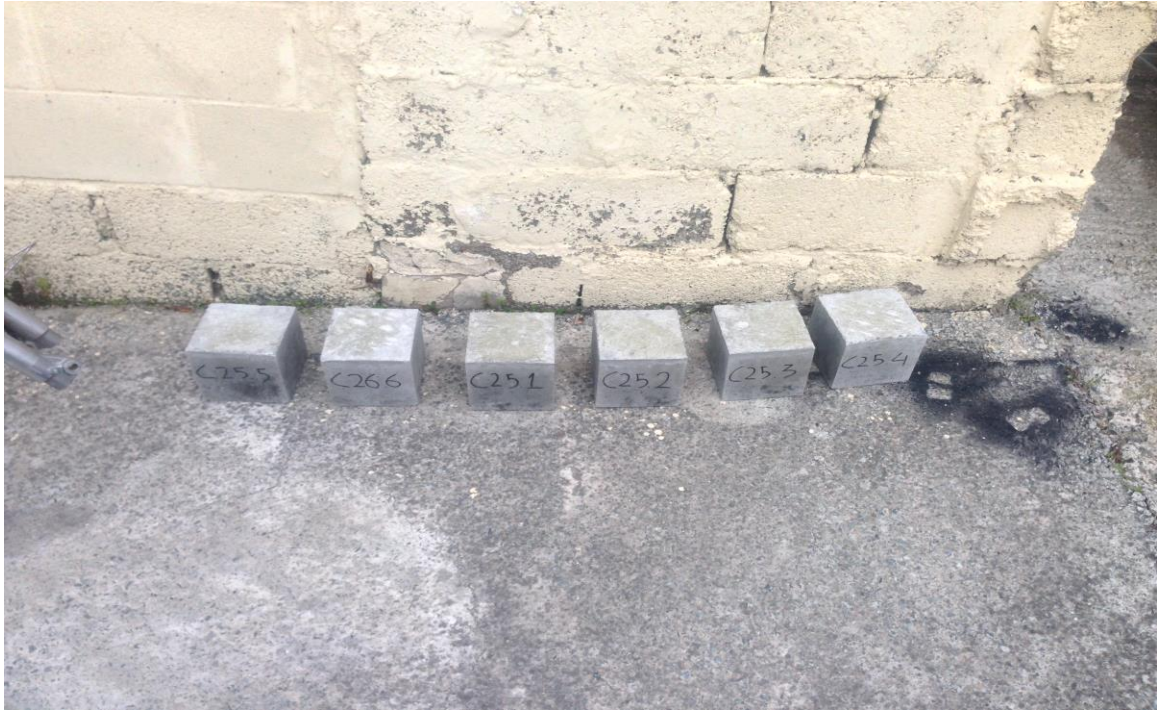
Εικόνα 12. Δοκμια εκτεθειμενα στη ατμοσφαιρα
