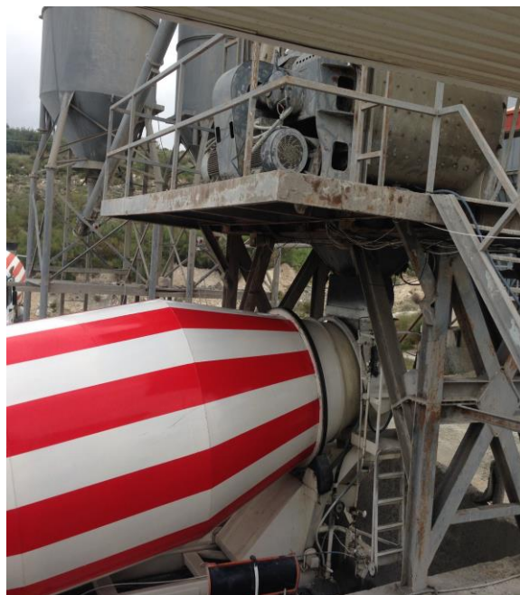
Εικόνα 4. Τοποθέτηση σκυροδέματος σε αυτοκίνητο.
