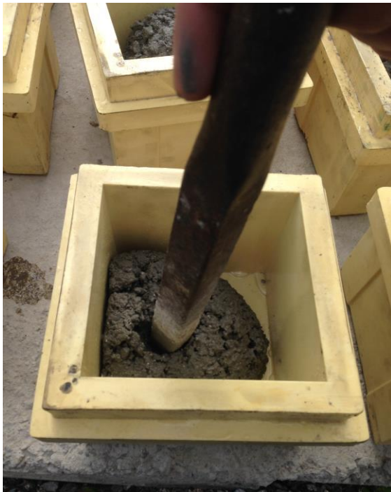
Εικόνα 8. Συμπύκνωση στρώσεως κυβου.
