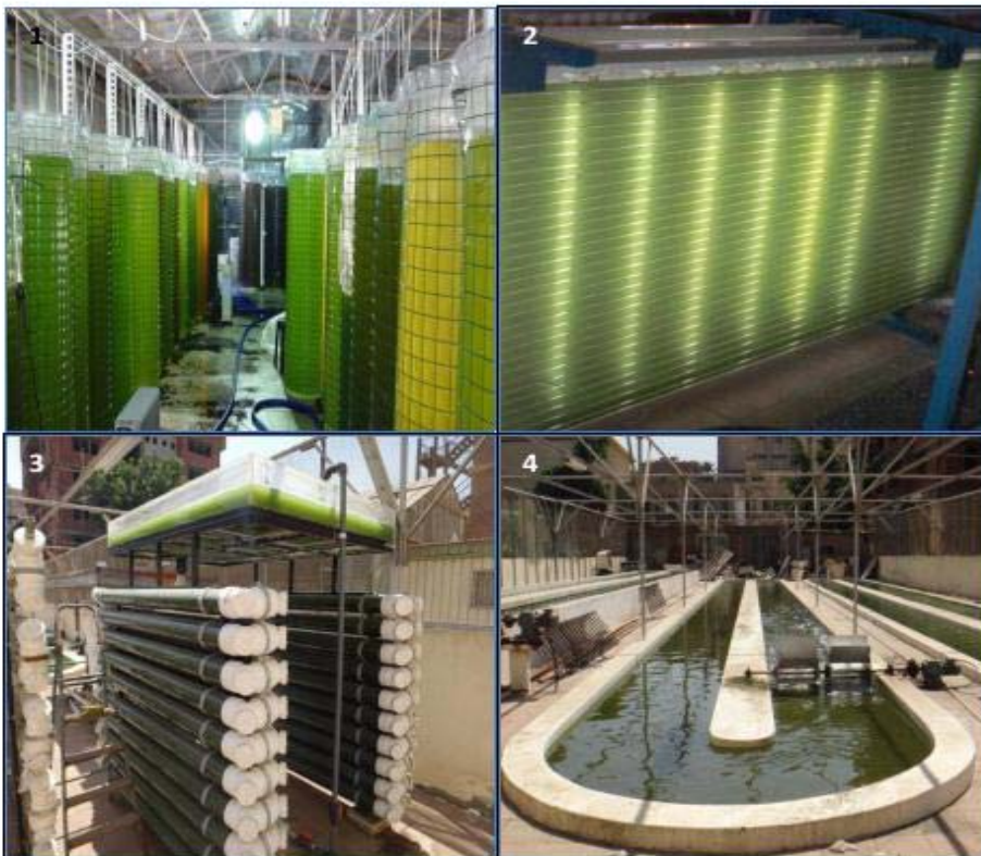
Σχήμα 4: Διάφοροι τύποι βιοαντιδραστήρων για την παραγωγή βιοπετρελαίου από άλγη.
