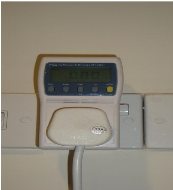
Εικόνα 1: Χρήση συσκευής μετρητή ενέργειας (energy monitor) σε πρίζα για μέτρηση των kWh.
