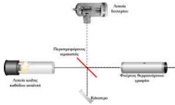
Σχήμα 1.48: Σχηματική παράσταση ενός συστήματος διόρθωσης υποβάθρου με ακτινοβολία πηγής συνεχούς φάσματος. Ο τεμαχιστής (chopper) μπορεί να παραληφθεί, εάν οι λυχνίες λειτουργούν εναλλασσόμενα.
