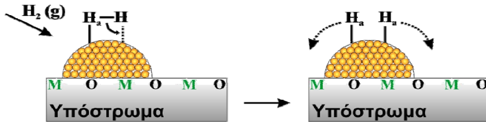
Σχήμα 1.19. Μηχανισμός διασπαστικής χημικής προσρόφησης υδρογόνου ( H_2(g) ) στη καταλυτική επιφάνεια και διάχυση του ατομικού H στο υπόστρωμα [90].
