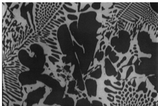
Σχήμα 1.64: Τυπική εικόνα ηλεκτρονικού μικροσκοπίου σάρωσης (SEM) κατανομής φάσεων από οπισθοσκοπεζόμενα ηλεκτρόνια. Οι λαμπρότερες επιφάνειες δηλώνουν φάσεις με μεγαλύτερο μέσο ατομικό αριθμό [163].
