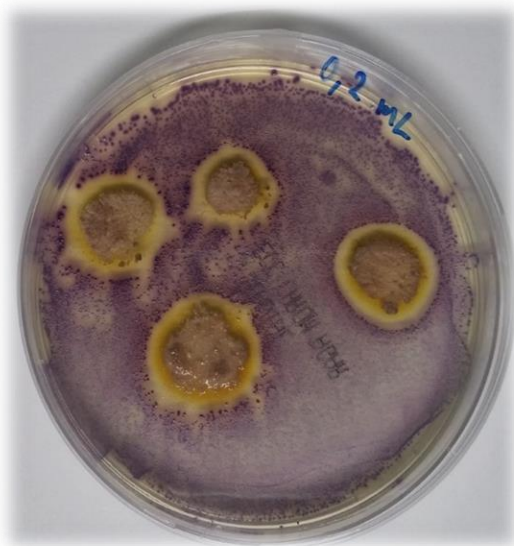
Σχήμα 4.3. Παρεμπόδιση της ανάπτυξης των αποικιών του βακτηρίου E. coli και ανάπτυξη αντιμικροβιακών ζωνών μετά την τοποθέτηση κονιορτοποιημένου στερεού 1% κ.β. Ag/γ-Al 2 O 3 σε συγκεκριμένα σημεία της επιφάνειας του θρεπτικού υποστρώματος.
