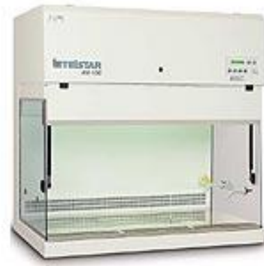
Σχήμα 2.35. Εικόνα θαλάμου νηματικής ροής που χρησιμοποιήθηκε στην παρούσα εργασία [195].
