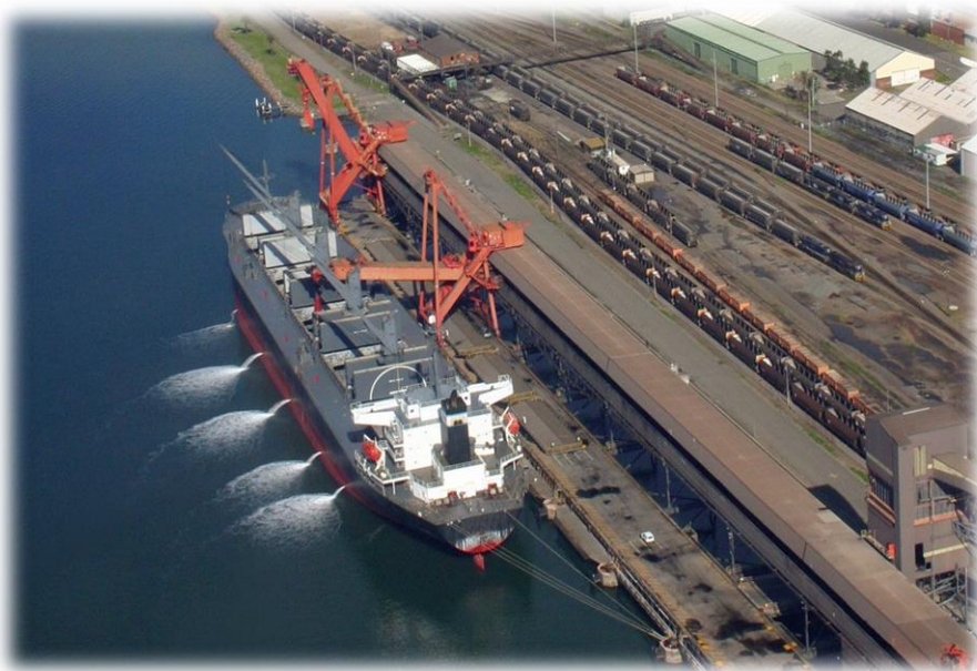
Σχήμα 1.5. Επεξεργασία του νερού έρματος σε λιμενικές εγκαταστάσεις [15].
