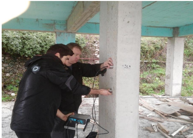
Εικόνα 55: Εφαρμογή μεθόδου των υπέρηχων ( http://okeanis.lib.puas.gr )
