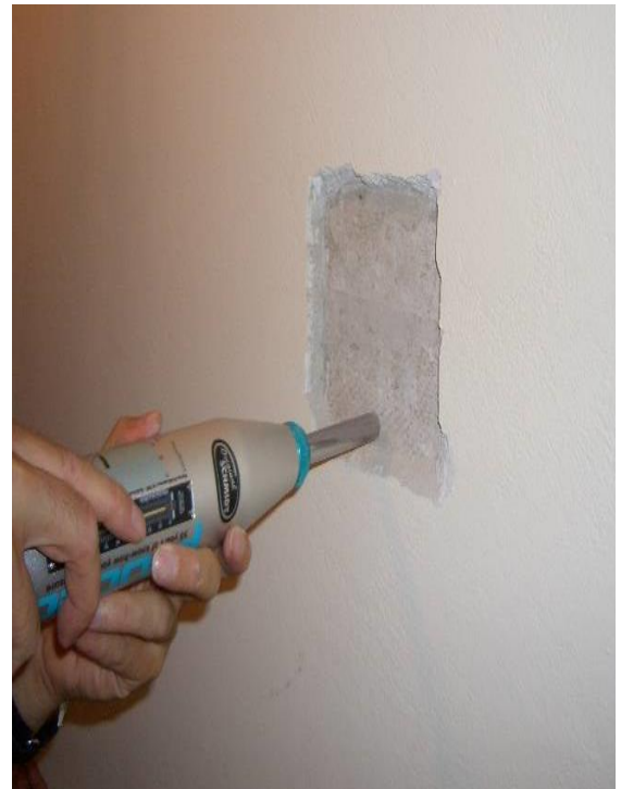
Εικόνα 54: Δοκιμή κρουσίμετρου σε τοιχείο ( http://sideris-konstantinos.blogspot.com )
