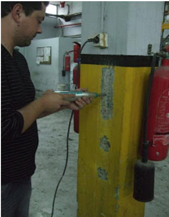
Εικόνα 53: Δοκιμή κρουσίμετρου σε υποστώλωμα ( http://sideris-konstantinos.blogspot.com )
