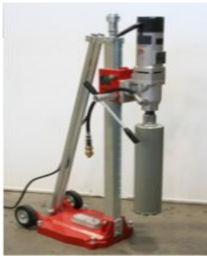
Εικόνα 61: Ειδικό διατηρητικό μηχάνημα λήψης πυρήνων στο σκυρόδεμα ( https://www.slideshare.net )
