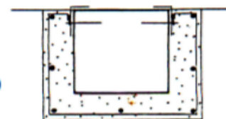
Εικόνα 78: Περιπτώσεις ανοικτών μανδύων (Δρίτσος 2005)
