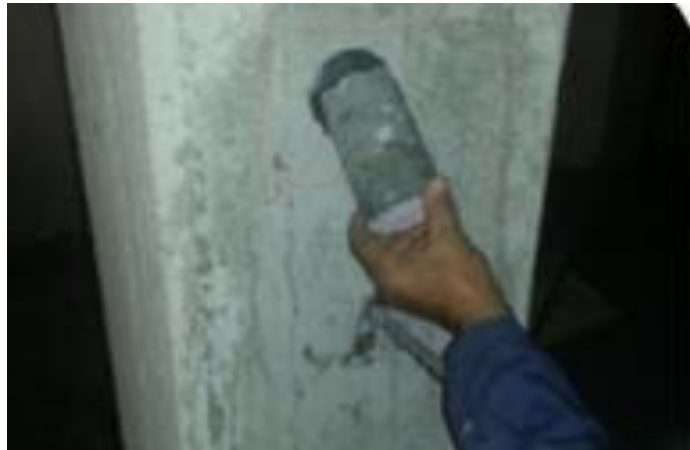
Εικόνα 62: Λήψη πυρήνα από το σκυρόδεμα ( https://www.slideshare.net )
