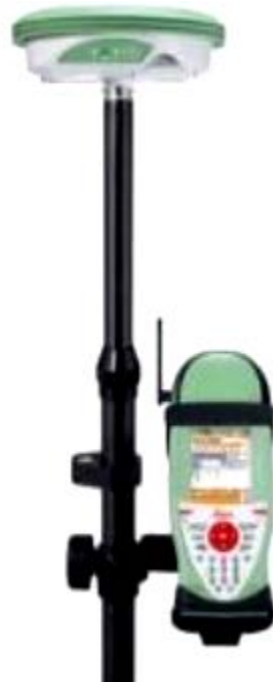
Διάγραμμα 4: Γεωδαιτικός Εξοπλισμός (GNSS receiver GPS vna G08 plus by Leica)
