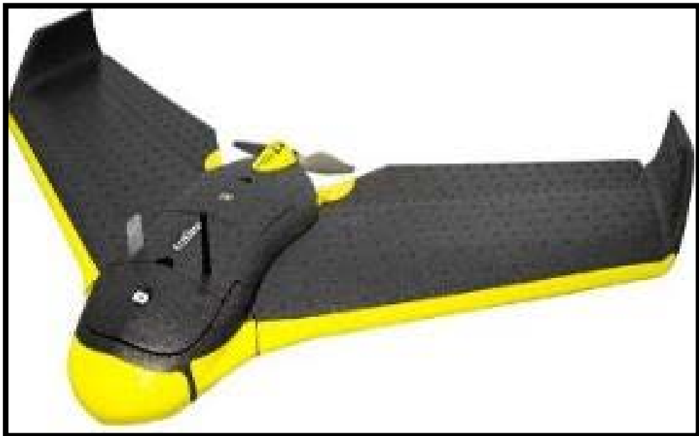
Διάγραμμα 3: UAV – eBee fixed wing από την SenseFly
