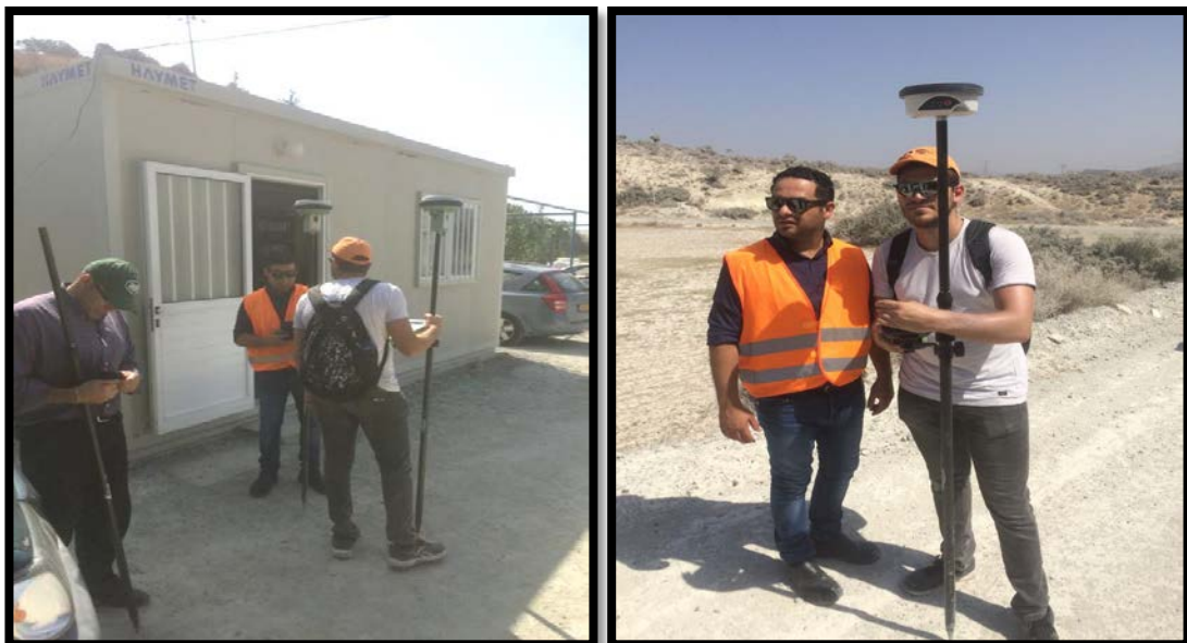
Διάγραμμα 42: Αποτύπωση σημείων στο πεδίο με χρήση GPS
