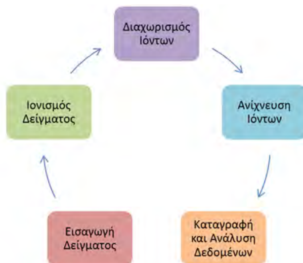
Σχήμα 2.17: Διάγραμμα λειτουργιών που λαμβάνουν χώρα σε ένα φασματογράφο μάζας.
