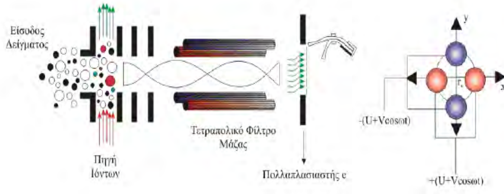
Σχήμα Ι.1: Σχηματικό διάγραμμα τετραπολικού αναλυτή μάζας [6].
