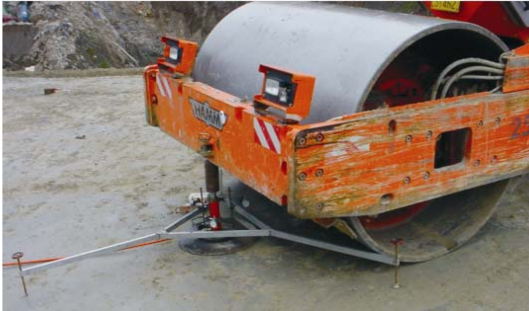
Εικόνα 3. Δοκμή φορτιζόμενης πλάκας
